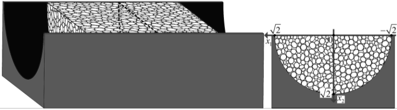
Рис. 2. Зображення насипу вугілля циліндричної форми та його перерізу, що описується областю \Omega = \{(x_1, x_2) : x_1^2 + x_2^2 \leq 2, x_2 \geq 0\}
